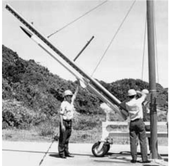
*Preparación de un cohete Sonda brasileño para su lanzamiento. Los instrumentos científicos de a bordo proveen información sobre las características de la ionosfera, excelente conductora de electricidad, sobre el ecuador magnético. Los cohetes Sonda se emplean como etapas de un cohete más grande de Brasil, el VLS, que está diseñado para poner satélites en órbita.*
