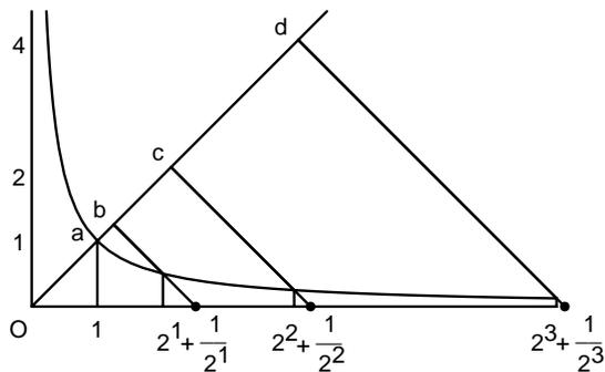
Cuando las líneas perpendiculares al eje se extienden hasta intersectar la asíntota, producen las longitudes  $(2^n + 1/2^n)$ . Por inversión, las longitudes correspondientes sobre el eje son proyecciones de estas longitudes en un ángulo de 45 grados. Por tanto, las longitudes  $Ob, Oc$  y  $Od$  son iguales a  $(2^n + 1/2^n)/2$ .
