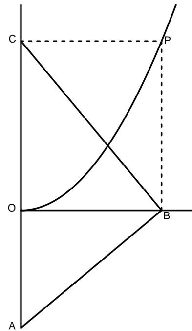
La parábola la forma el ángulo móvil ABC, tal que el vértice B se mueve sobre la línea OB en tanto C se mueve sobre la línea OC. Esto forma el rectángulo cambiante OBPC. El punto P describe una parábola. Mediante triángulos similares,  $OA:OB::OB:OC$  o  $OC = OB^2$ .
